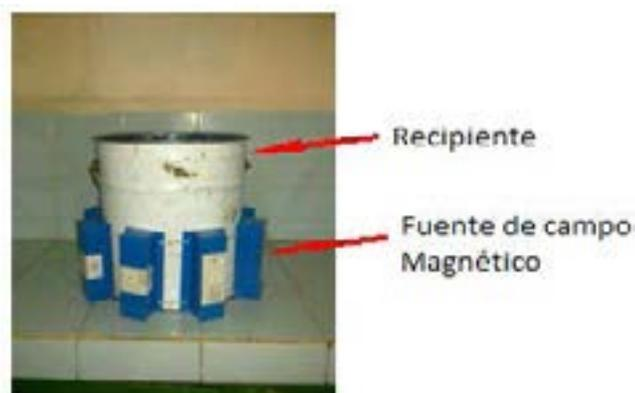
Figura 1: Recipiente donde se prepara la semilla y fuente de campo magnético utilizada.
